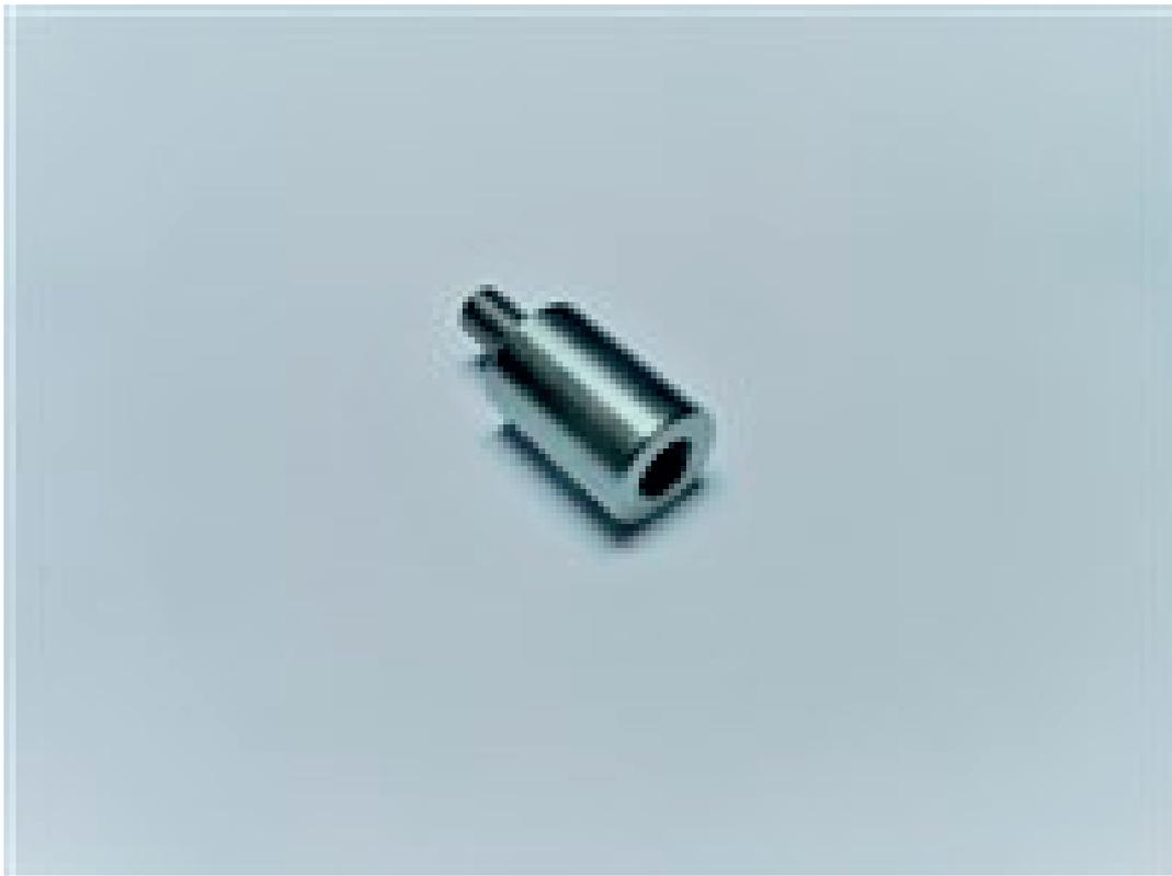
Gewindehülse Stahl; M6 Außengewinde - M6X0,5 Feingewindebohrung
