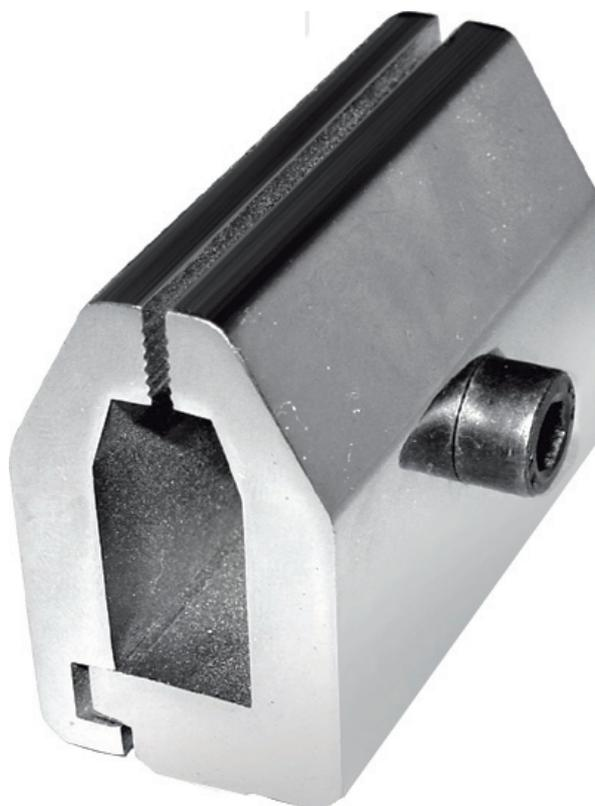
Morsetto a vite per prove di trazione
