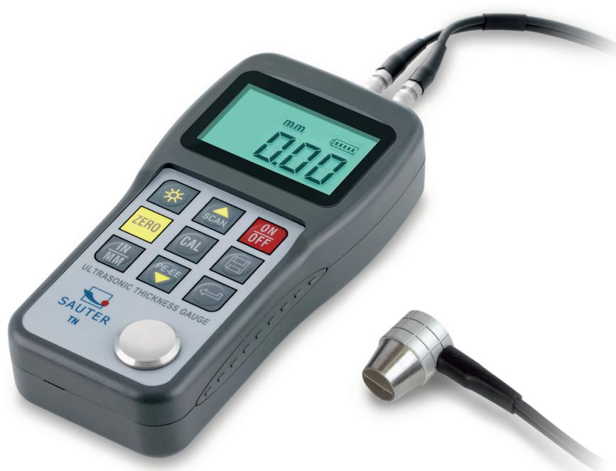
Handmessgerät für Materialdicke
