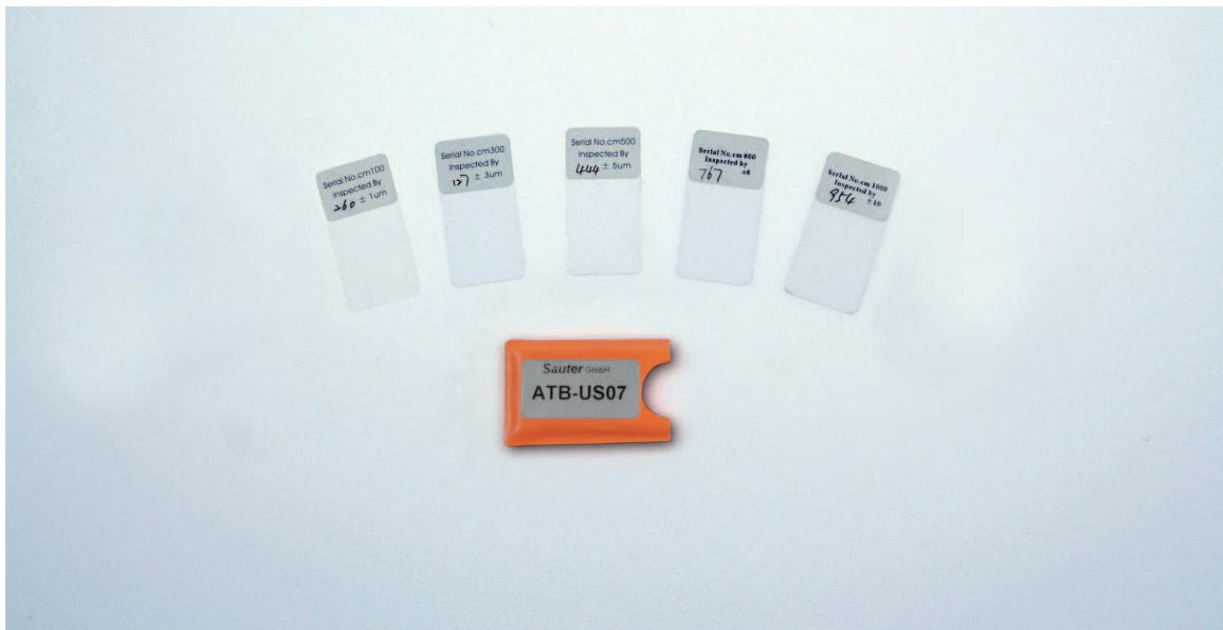
Justierfolien für erhöhte Messgenauigkeit (decken den Bereich von 20 bis 2000 µm ab, bei 3 ? % Toleranz)
