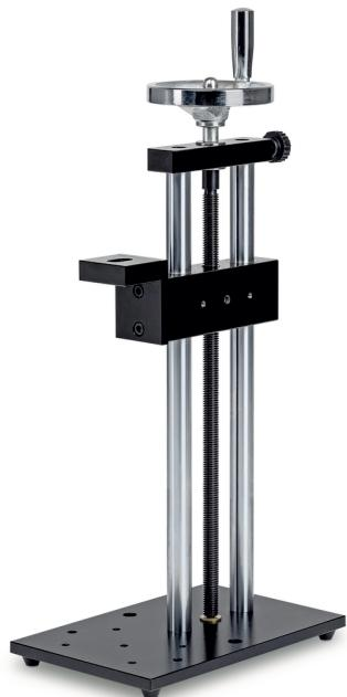
Banco di prova per strumenti di misurazione per forze con cella di misura esterna
