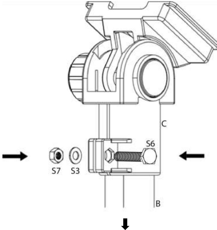
⇒ Introduzir o suporte **(C)** da unidade de visualização na extremidade superior do tubo do suporte **(B)** e fixar com o parafuso **(S6)**.
