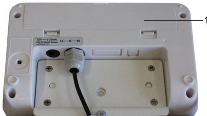
Открыть крышку отсека аккумулятора [1] внизу дисплея и подключить аккумулятор.
