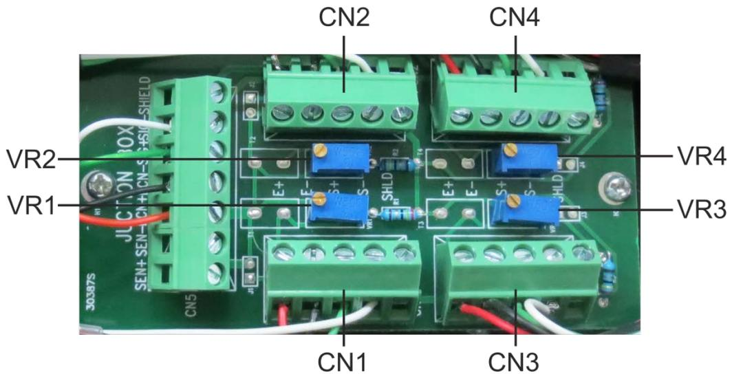
L'ajustage de la cellule de pesée CN1 s'effectue sur la paire de potentiomètres VR1.
