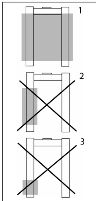
Le pont-bascule en U a été construit pour une charge également distribuée
