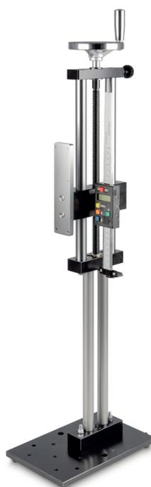
Banco di prova manuale per prove di trazione e compressione ad alta precisione, con misurazione della lunghezza
