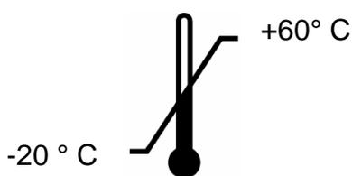
Limitation de la température avec indication de la limite inférieure et supérieure (température de stockage sur l'emballage)
