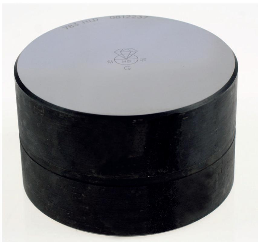
Bloque de verificación tipo D/DC, precisión = 4 HL, Ø 90 mm (± 1 mm), peso neto aprox. 2,7 kg, rango de dureza 790 ± 40 HL
