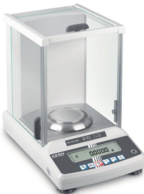
El modelo superior con sistema de pesaje Single-Cell
