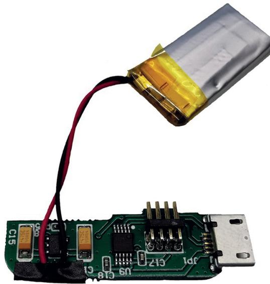
Circuito, circuito di carica della batteria + batteria
