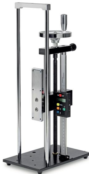
Manueller Prüfstand für hochgenaue Zug- und Druckkraftmessungen, mit Längenmessung
