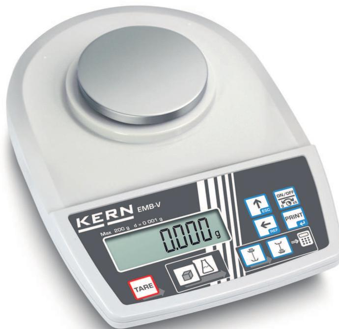
Schulwaage mit integrierter Dichtebestimmungsfunktion
