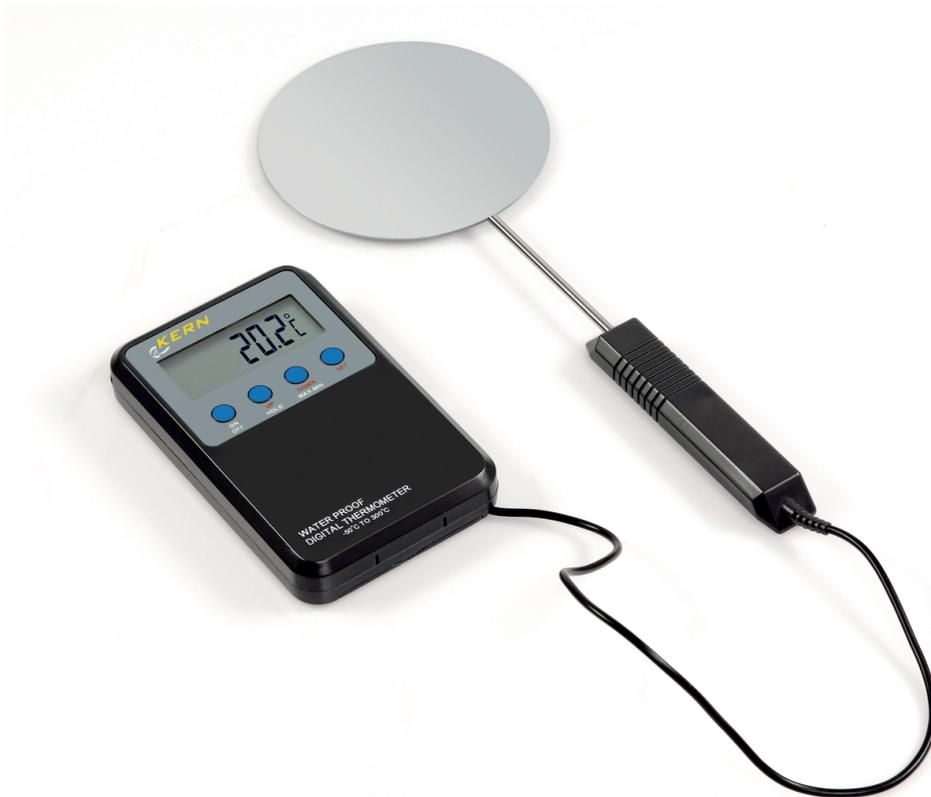
Set de calibración de temperatura compuesto por una sonda medidora y un indicador
