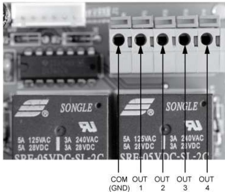
**¡No cambiar las conexiones „COM”! (GND)**
