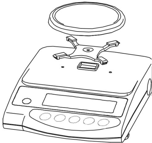
Atornillar el soporte según dibujo y luego colocar el platillo.
