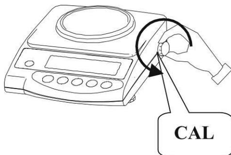
El aparato procede al ajuste automático. Aparece, parpadeando, la indicación [**CAL.on**].
