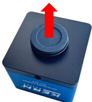
Entfernen Sie die schwarze Abdeckung an der Unterseite des Kameragehäuses. Ziehen Sie anschließend, falls vorhanden, die Schutzfolie über dem Sensor ab (gilt nicht für alle Modelle).
