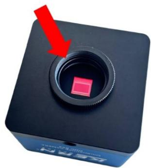
Unter der Abdeckung befindet sich ein genormtes C-Mount-Gewinde. Dieses dient zur Montage auf einen C-Mount-Adapter.
