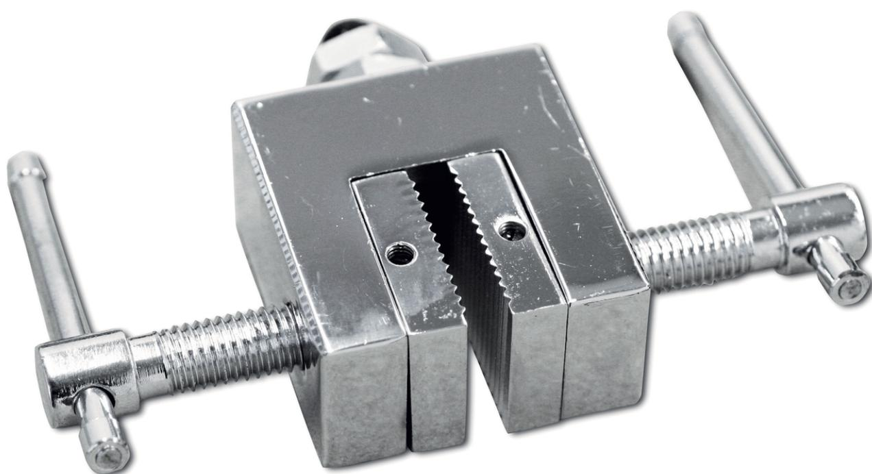
Pince universelle à mâchoire double pour tests de traction et de déchirement
