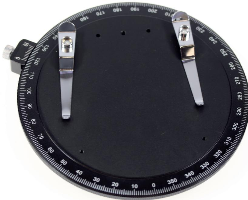
Runder Drehtisch für Polarisationsmikroskope
