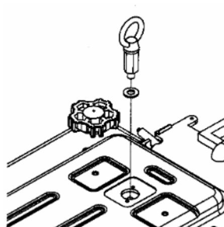
4. Posizionare la rondella sul foro e avvitare con cautela il gancio per pesatura in sospensione fino al fondo (serrare manualmente → un serraggio eccessivo potrebbe danneggiare la bilancia).
