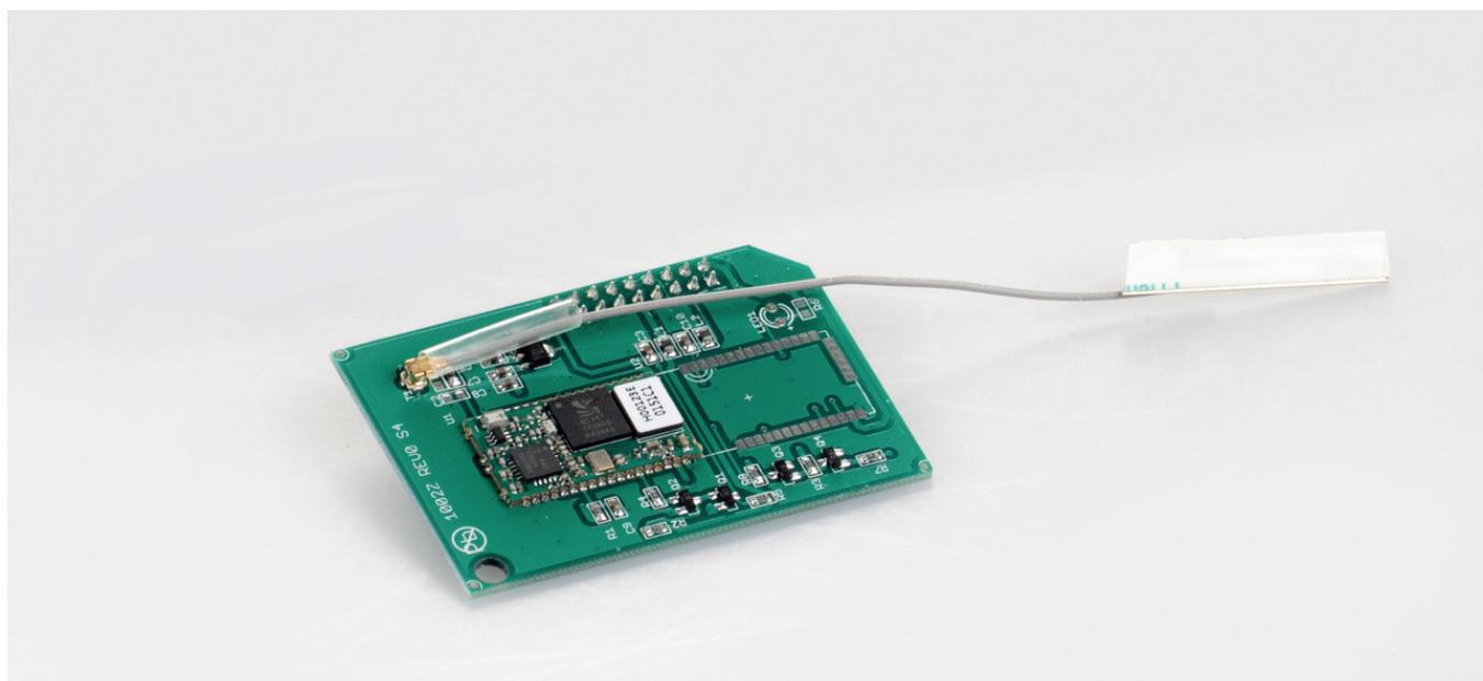
Interfaccia dati Bluetooth, non compatibile con iOS (solo per modelli non omologati)
