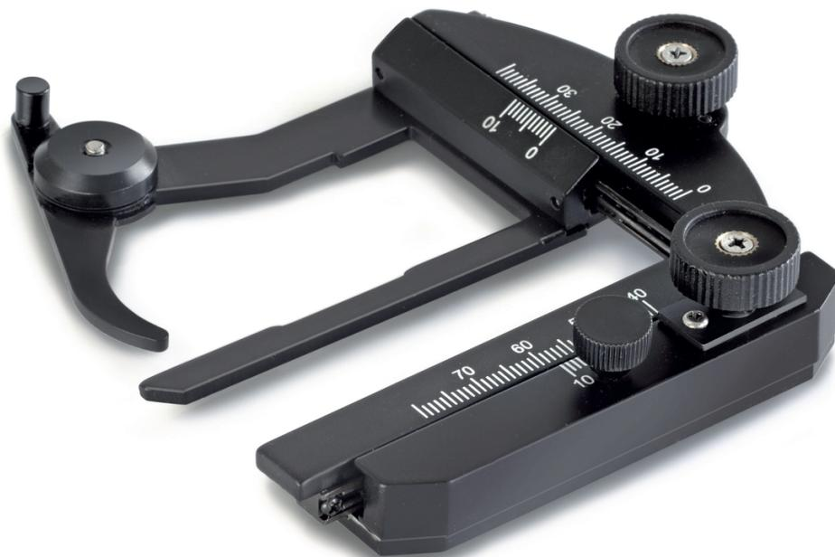
Extensión mecánica para la mesa de polarización, (Luz incidente) + (Luz transmitida)
