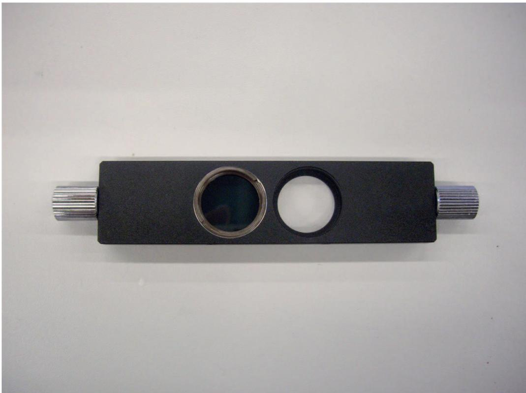
Deslizador del polarizador
