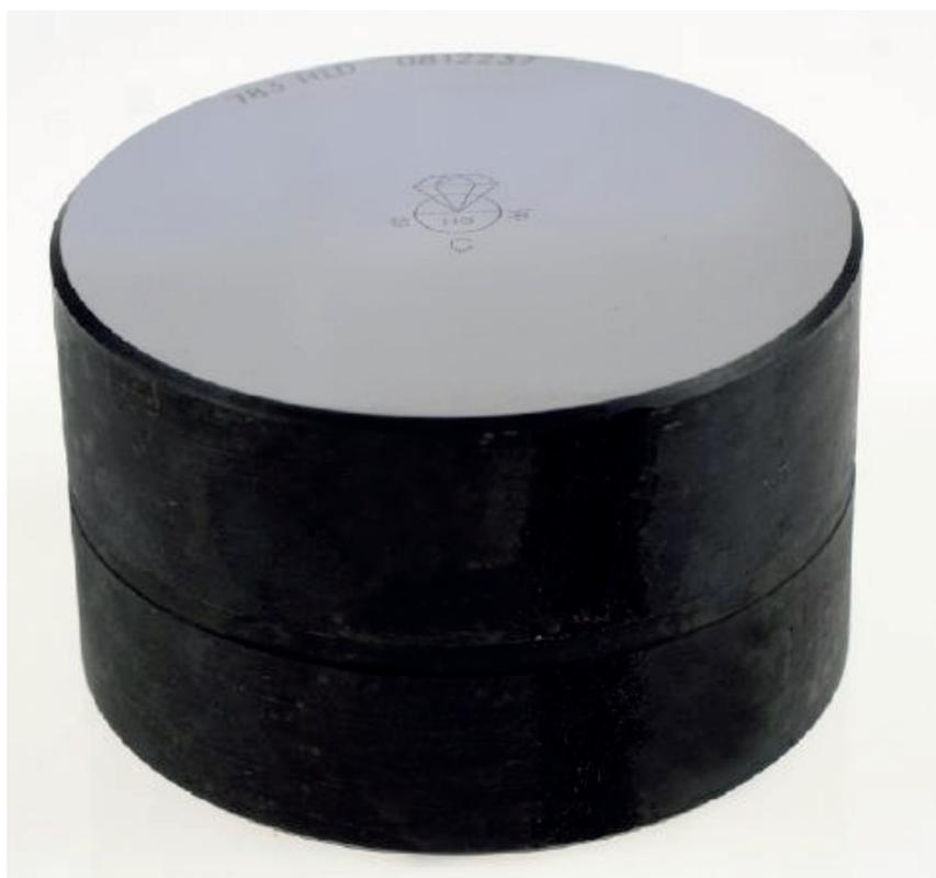
Bloc de contrôle type D/DC, précision  $\geq 4$  HL,  $\varnothing$  90 mm ( $\pm 1$  mm), poids net env. 2,7 kg, plage de dureté 630  $\pm$  40 HL
