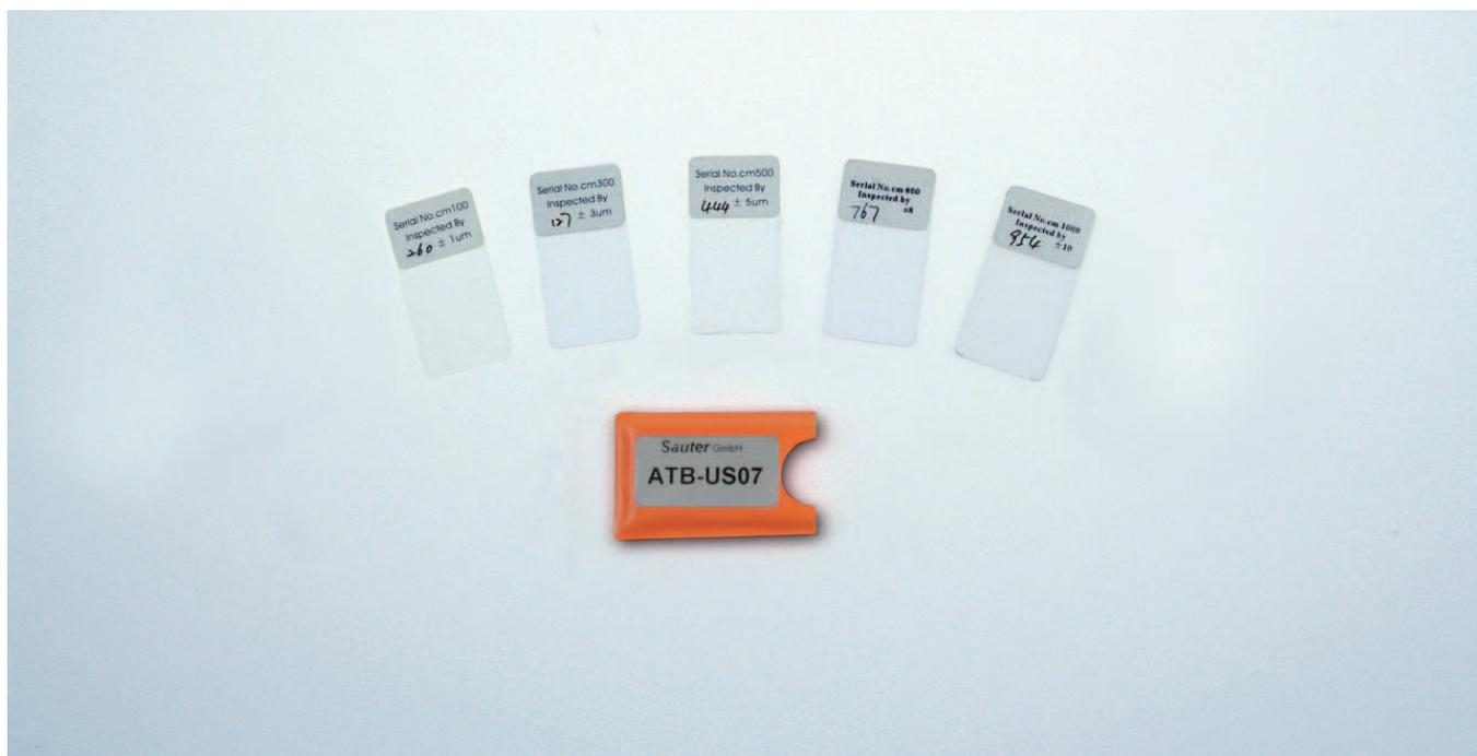
Feuilles d'ajustage pour une exactitude de mesure élevée (couvre la plage de 20 à 2000  $\mu\text{m}$ , avec une tolérance ? 3 %)
