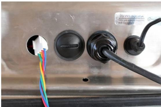
Guidare il cavo interfaccia attraverso l'apertura sul terminale
