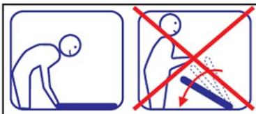
Bei den Waagen mit großer und schwerer Plattform ist beim Aufbau und beim Transport ( Wägeplatte hochgeklappt ) darauf zu achten, dass die Waage nicht umfällt und beschädigt wird.
