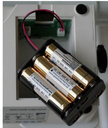
⇒ Batteriehalterung mit den eingelegten Batterien in das Anzeigergerät einlegen
