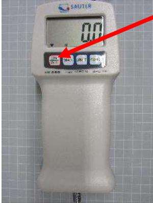
2. Non appena sul display appare "0", premere contemporaneamente il pulsante **"UNIT"** e il pulsante **"ZERO"** finché sul display non appare **"CAL"**.
