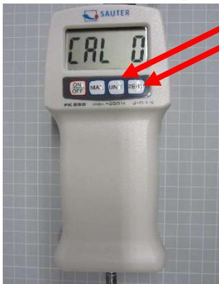
3. Dopo alcuni secondi, sul display appare il **peso di calibrazione** richiesto, ad esempio 5,00 kg per il modello FK 50 o 10,00 kg per il modello FK 100.
