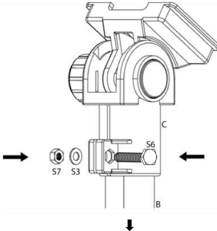
⇒ Halter (**C**) für das Anzeigegerät in das obere Ende des Stativrohrs (**B**) stecken und mit der Schraube (**S6**) befestigen.
