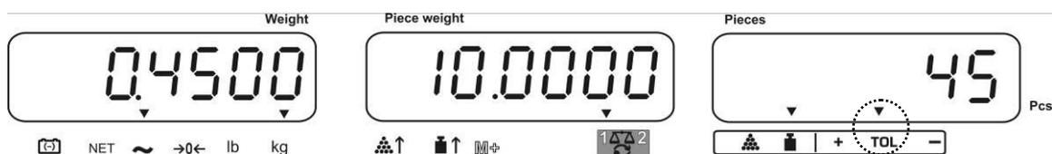
La aparición del símbolo de tolerancia ▼ cuando la masa del material se encuentra por encima del rango de tolerancia determinado:
