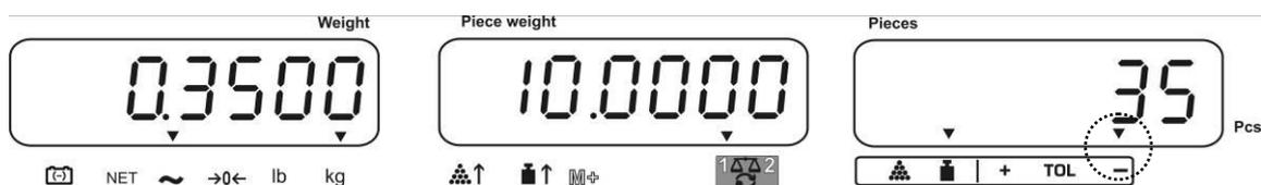
La aparición del símbolo de tolerancia ▼ cuando la masa del material se encuentra dentro del rango de tolerancia determinado.
