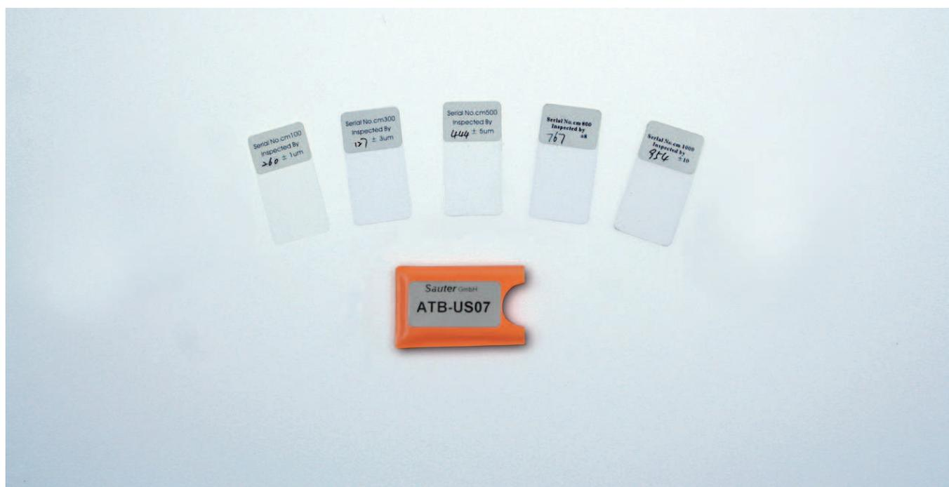
Pellicole di calibrazione per una maggiore precisione di misurazione (copre l'area da 20 fino a 2000  $\mu$ m, con tolleranza ? 3 %)
