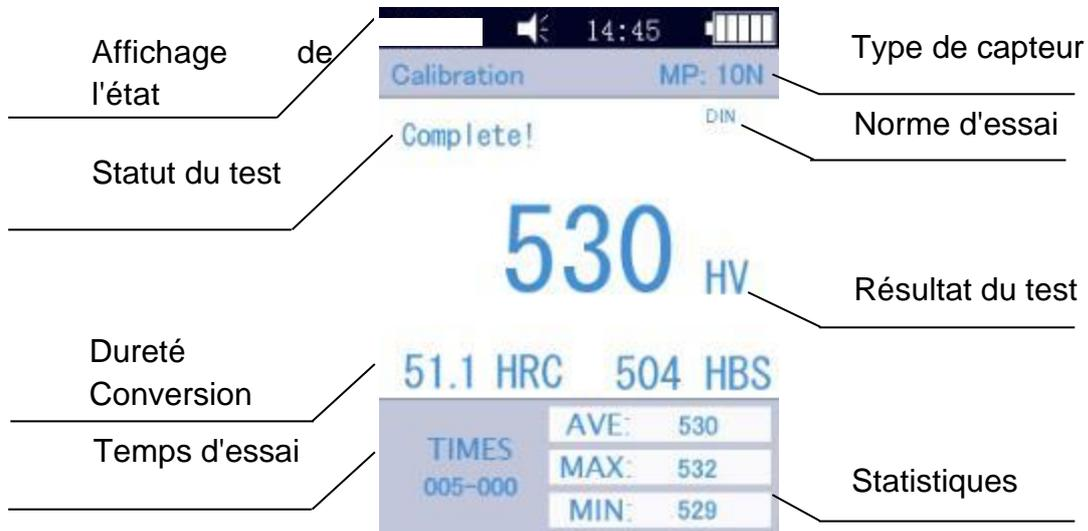
Les écrans de menu contiennent l'affichage de l'état, l'information sur le modèle, l'information sur l'étalonnage, l'affichage du test, la liste des résultats et la liste d'information sur les résultats du test, comme le montre la Fig. 6-3.
