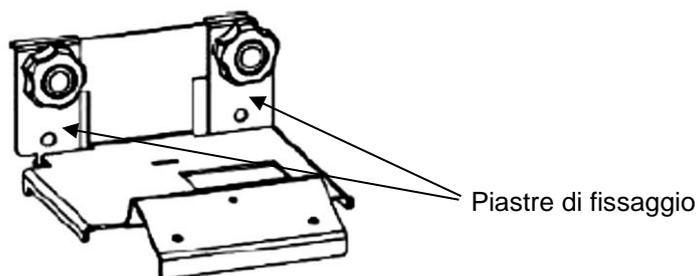
10. Agganciare le piastre di fissaggio al vano cavi e stringerle un po' manualmente utilizzando le manopole [9].
