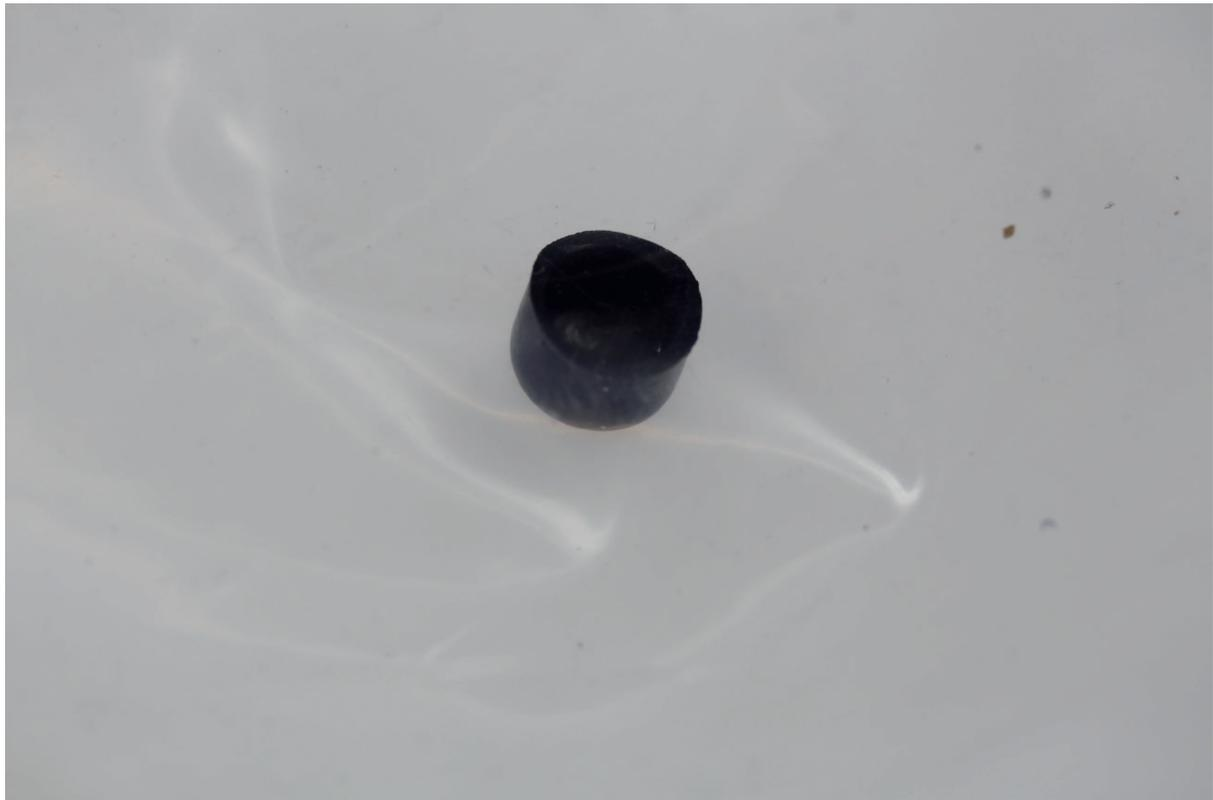
Cubierta para tornillo de calibración para refractómetro analógico
