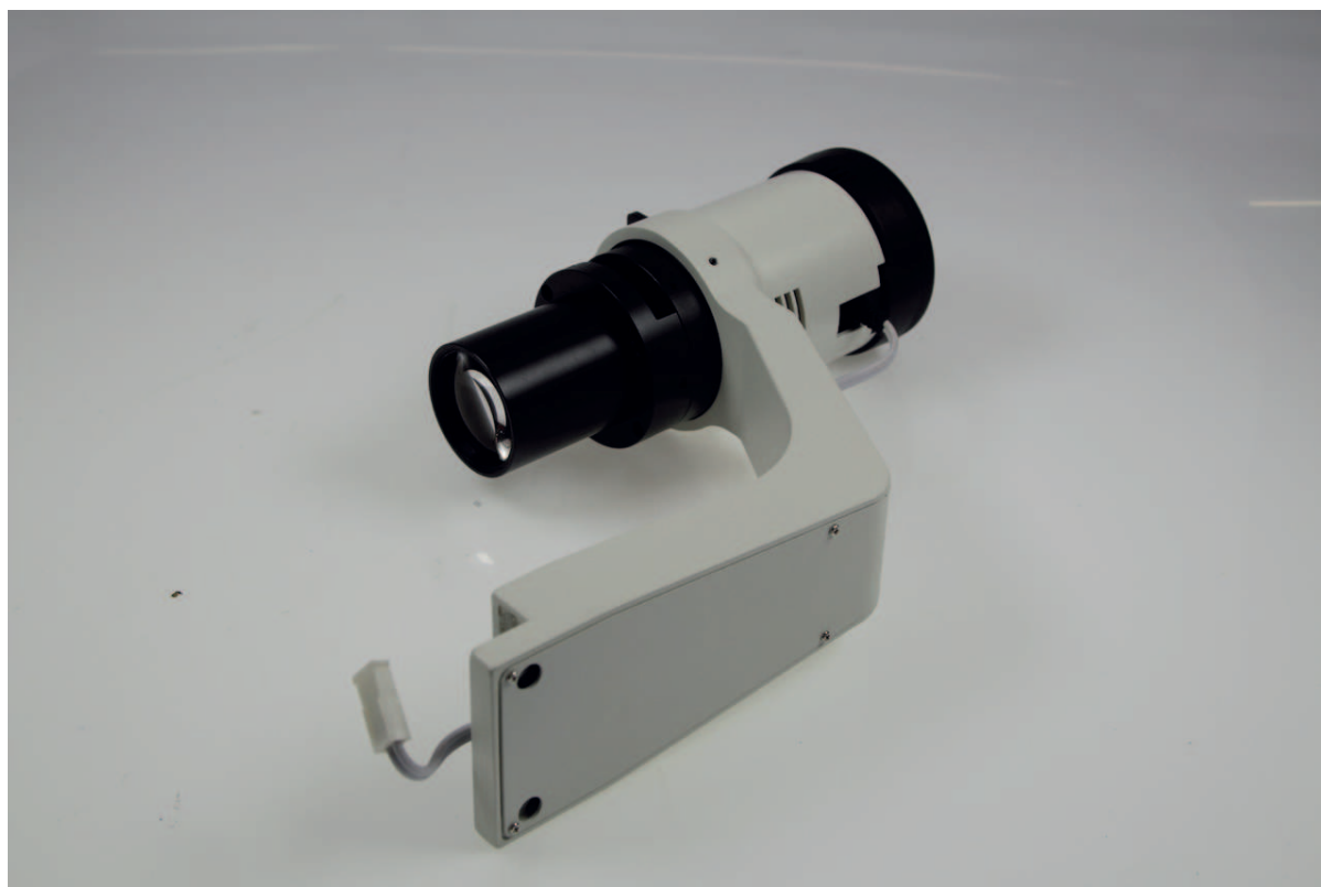
Condensateur d'Abbe à ouverture numérique (avec diaphragme d'ouverture)
