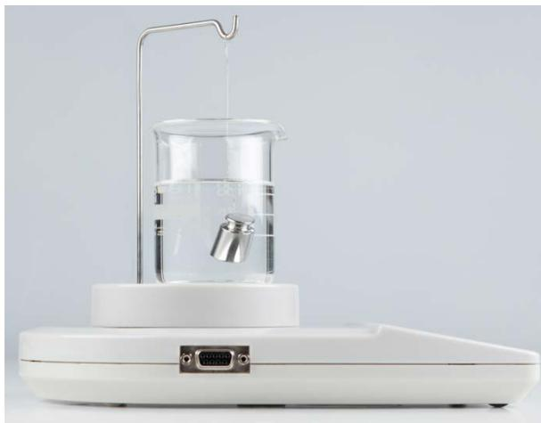
⇒ Aspettare la visualizzazione dell'indice di stabilizzazione. Leggere e notare il valore di massa del campione.
