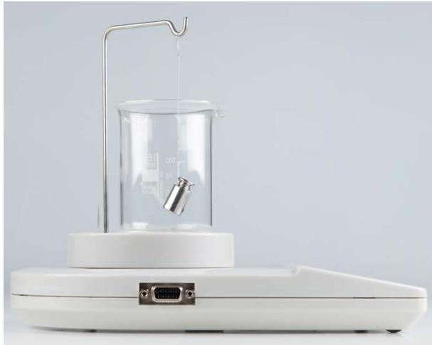
⇒ Aspettare la visualizzazione dell'indice di stabilizzazione. Leggere e notare il valore di massa del galleggiante.
